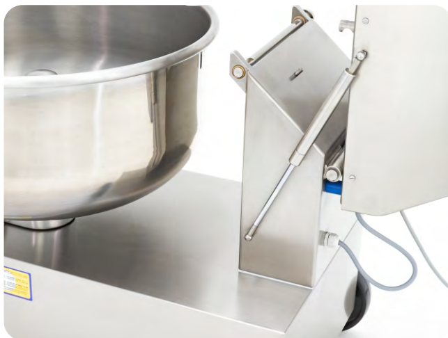
Kippbares Maschinenoberteil mit Gasfeder-Unterstützung.
