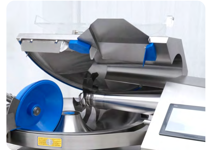
Motorisierter Edelstahl-Messerdeckel für müheloses Anheben und Absenken.
