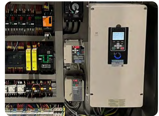
Sanfter Anlauf und Stopp von Messern, Schüssel und Auswerferscheibe durch elektronische Frequenzumrichter.
