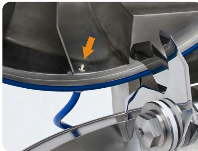
Sensibles Digital-Thermometer mit verlängertem Sensor.
