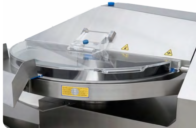
Transparente Lärmschutzhaube, Reduktion der Messergeschwindigkeit beim Öffnen / Zurückfahren auf die vorherige Geschwindigkeit beim Schließen.
