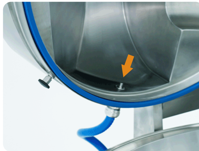
Sensibles Digital-Thermometer mit verlängertem Sensor.
