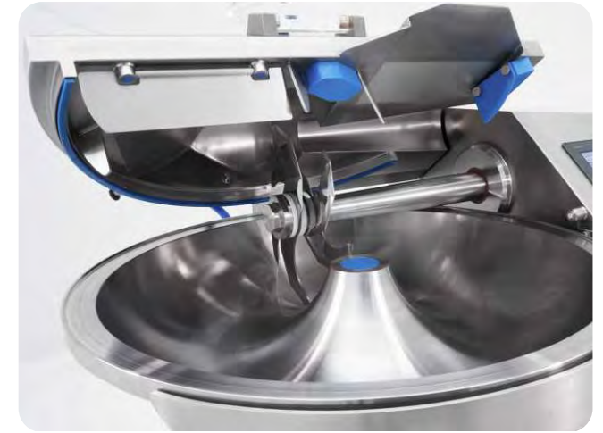
Motorisierter Edelstahl-Messerdeckel für müheloses Anheben und Absenken.
