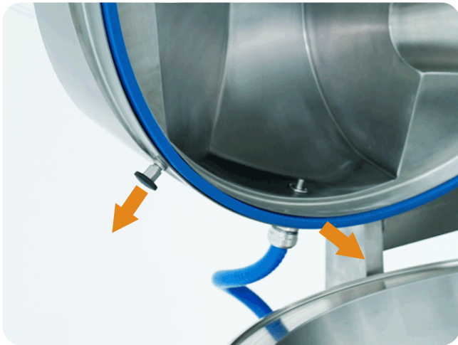
Abnehmbare Dichtung zwischen Deckel und Schüssel, selbstnachstellend durch Federn.
